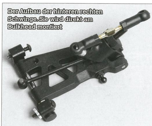
Der Aufbau der hinteren rechten Schwinge. Sie wird direkt am Bulkhead montiert
