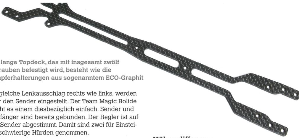
Das lange Topdeck, das mit insgesamt zwölf Schrauben befestigt wird, besteht wie die Dämpferhalterungen aus sogenanntem ECO-Graphit
